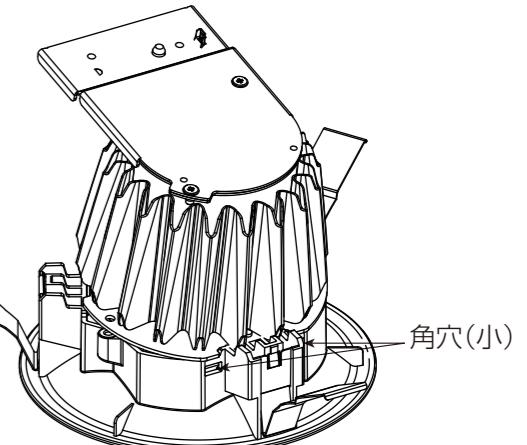
(2) ライトユニットの固定爪を反射板枠の角穴(大)に1ヶ所カチッと音がするまで押し込む。
