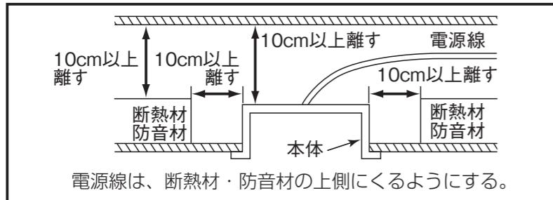
電源線は、断熱材・防音材の上側にくるようにする。
