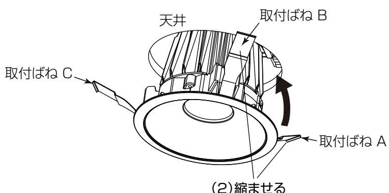
(3) 取付ばねCを縮ませ、埋込穴に挿入する。
