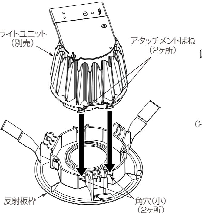
(1) ライトユニットのアタッチメントばねを反射板枠の角穴(小)に2ヶ所引掛ける。
